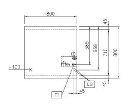
Electrical inlet (power) Equipotential screw Electric
